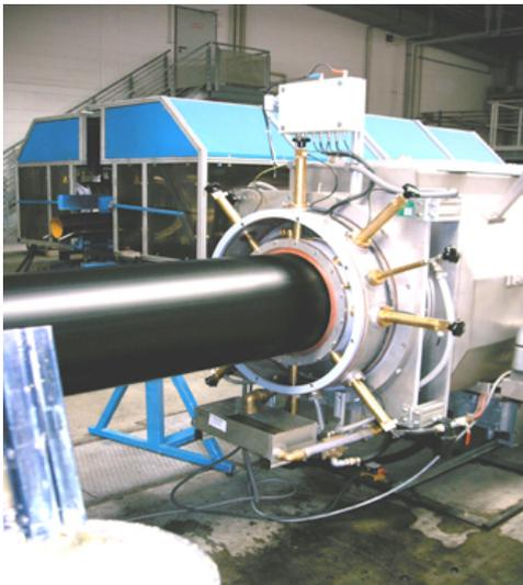
Die Überwachung und Vermessung der Kunststoffrohre erfolgt mit Hilfe von Ultraschall.
