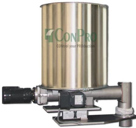
在对材料进行称重和送料时，必须保持材料输出是稳定的。为了在输送不易流动材料时达到同样的效果，S/M-KTW-F 被设计出来。集成在内的搅拌器避免了材料之间桥接的生成，并且持续不断地填充送料螺杆。平台称重计记录单位内的重量。通过重量损失来计算和调节产能。
