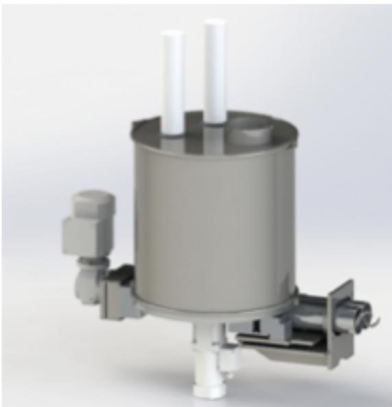
在称量和计量材料时，必须保持材料排放不变。为实现这一目标，S / M-KTW-SD是针对低流动性材料开发的。集成的激活器可防止桥接并确保永久填充的双螺旋。平台称重计记录单位内的重量。通过重量损失来计算和调节产螺旋。
