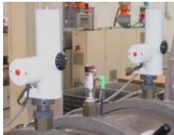
Die Überwachung und Vermessung von Kunststoff- Schläuchen und Tuben erfolgt mit Hilfe von Ultraschall. Die Sensoren sind in der Arbeitsstellung fixiert.
