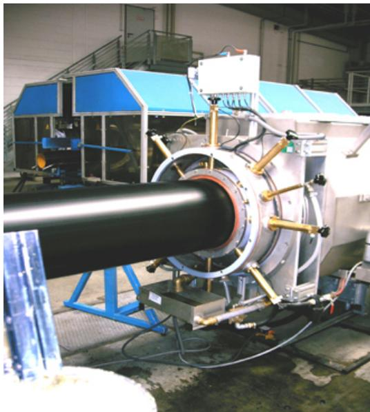
La surveillance et la mesure des tuyaux en plastique se fait à l'aide d'ultrasons. La chambre de mesure du type MH est rabattue à l'arrière du vide ou du réservoir de refroidissement. Grâce au dispositif de charnière, l'échange de joint est facile à effectuer.
