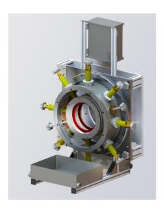
SoniCon SL / MH является всемирно известной системой измерения, ультразвукового проверки и контроля труб после прохождения вакуумного или охладительного резервуара. Измерение производится помощью неподвижно расположенных ультразвуковых датчиков. Измеряются толщина стенок, эксцентрицитет, внутренний И наружный диаметры, а также овальность.
