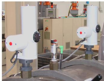
La surveillance et la mesure des tuyaux et des tubes en plastique se fait à l'aide d'ultrasons. Les capteurs sont fixés dans la position de travail.
