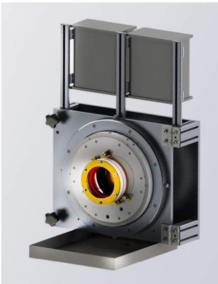
对塑料管材的测量和监督是通过超声波技术进行的。该测量系统的基础是采用弧形传感器，将其围绕管材进行环状安装。通过重叠安装好的传感器将超声波信号对管材的表面积进行了无缝式覆盖。上述测量系统已经得到实践认证，其产品名称为 SoniCon-SL/MRT。标准情况下使用 12 个传感器。
