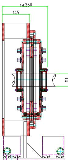
**MRT** 型号的测量舱一般安装在最后的冷却箱后面的法兰上（特别是为了 **100%** 质量监督）。
