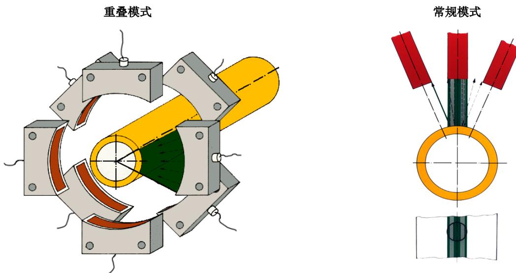
使用 ConPro MRT 测量系统和环装重叠式传感器可以让超声波无缝均匀的覆盖管材所有的表面。所有的超声波脉冲会由发射它的传感器再次接收。
